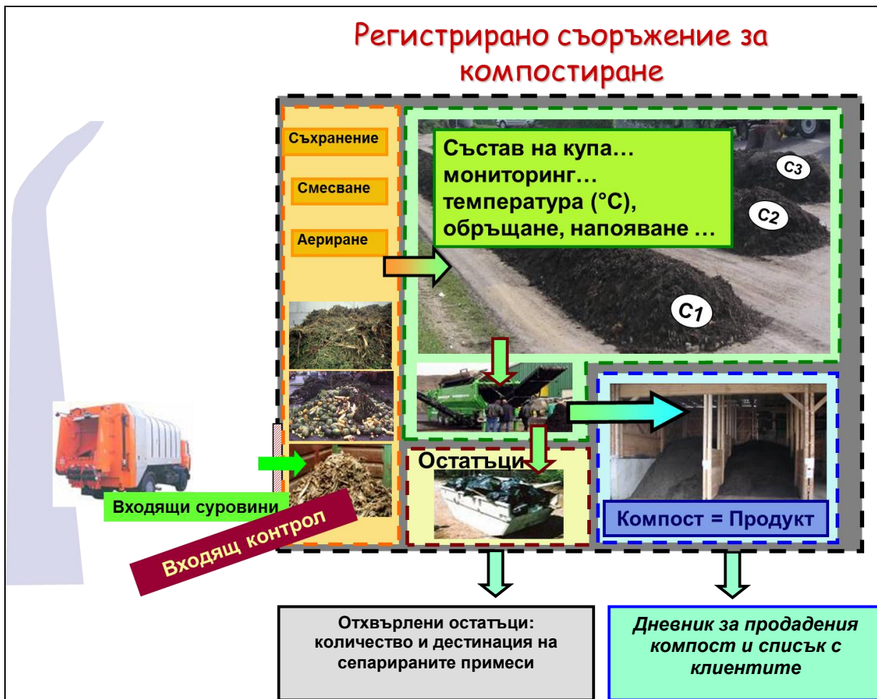
Фигура 6: Система за документиране и проследимост на процесите в съоръжението за компостиране
