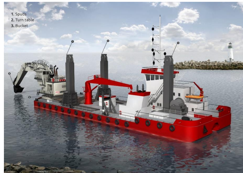
Фигура 3-2 Механична драга с обратна лопата
