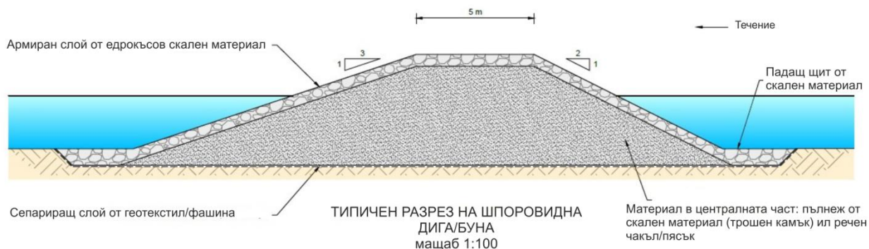
Фигура 3-5 Напречен разрез шпоровидна дига/буна
