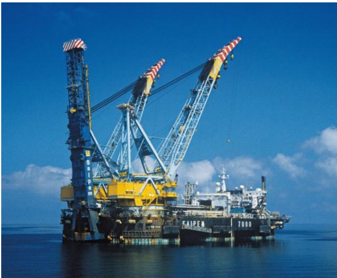
Фигура 4.4: Типична тръбополагаща баржа по метода на J-образно полагане
