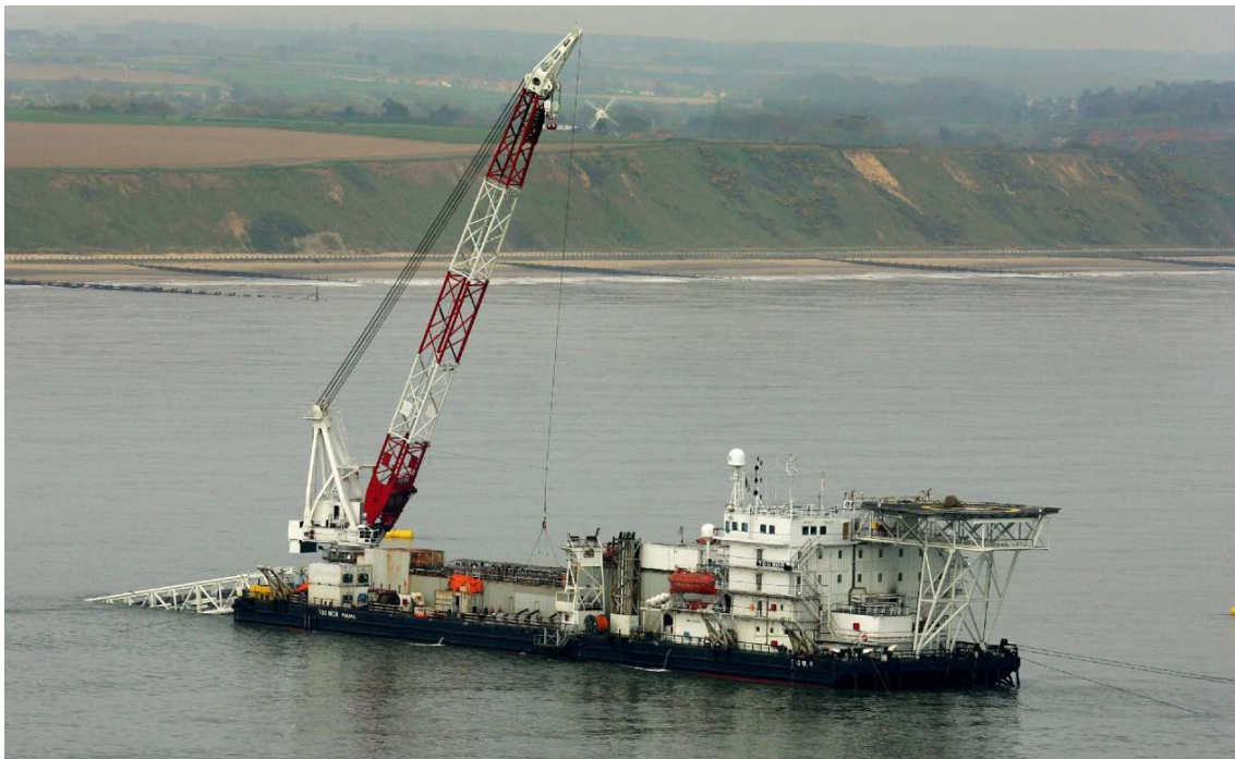
Фигура 4.10: Типична тръбополагащата баржа използвана от метода на S-образно полагане
