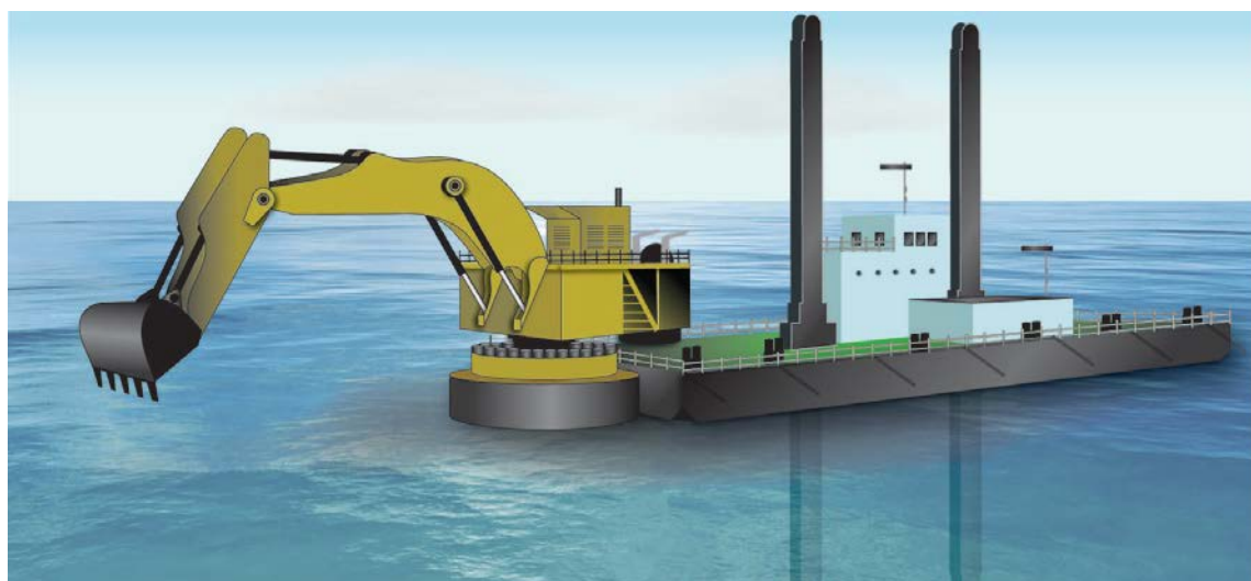
Фигура 4.8: Схема на драга с обратна лопата
