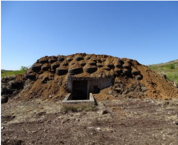
Фигура 29: Подобните на бункери укрития от автомобилни гуми, засипани със земна маса
